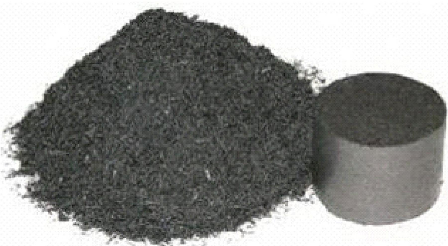
铁屑压块机是金属屑压块机的专属机型，通过大的压力将各种铁屑压制成为 3~7 公斤的高密度压块，达到再回收利用的目的。
